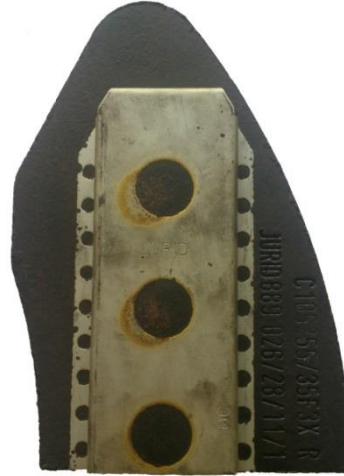
Figura N° 4. Vista posterior, porta pastilla y codificación, pastilla de freno trenes CAF, línea 1, Metro de Caracas
