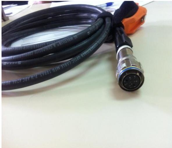
Figura 26 Terminación de Cable de Fibra óptica *outdoor* en el Brick
