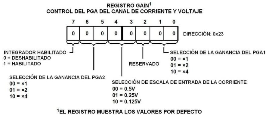
**Figura 14. Configuración de la ganancia del PGA del ADE7758**
