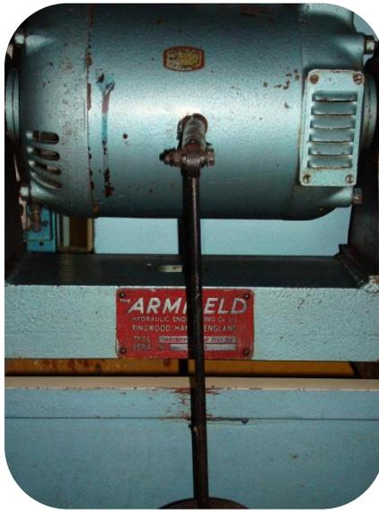
Foto. 61. Vista frontal del mecanismo empleado para medir par.
