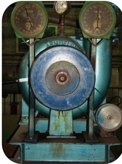
Foto. 46. Freno empleado para disipar la energía generada por la T.F.
