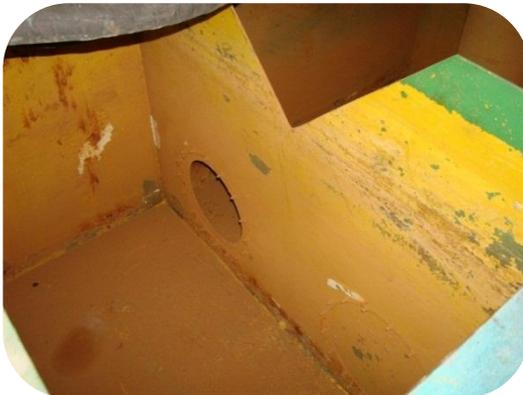
Foto. 44. Vista interna del tanque de agua y placa orificio.
