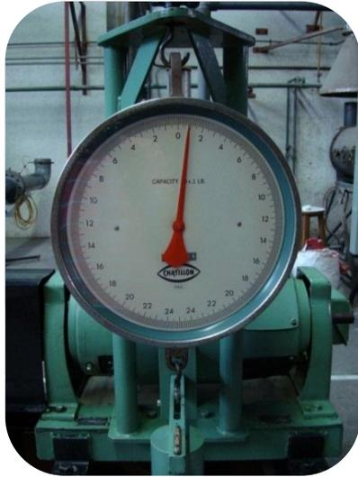
Foto. 77. Vista frontal delantera del mecanismo usado para medir par.
