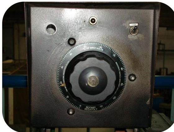
Foto.65. Vista frontal del regulador de velocidad del motor.
