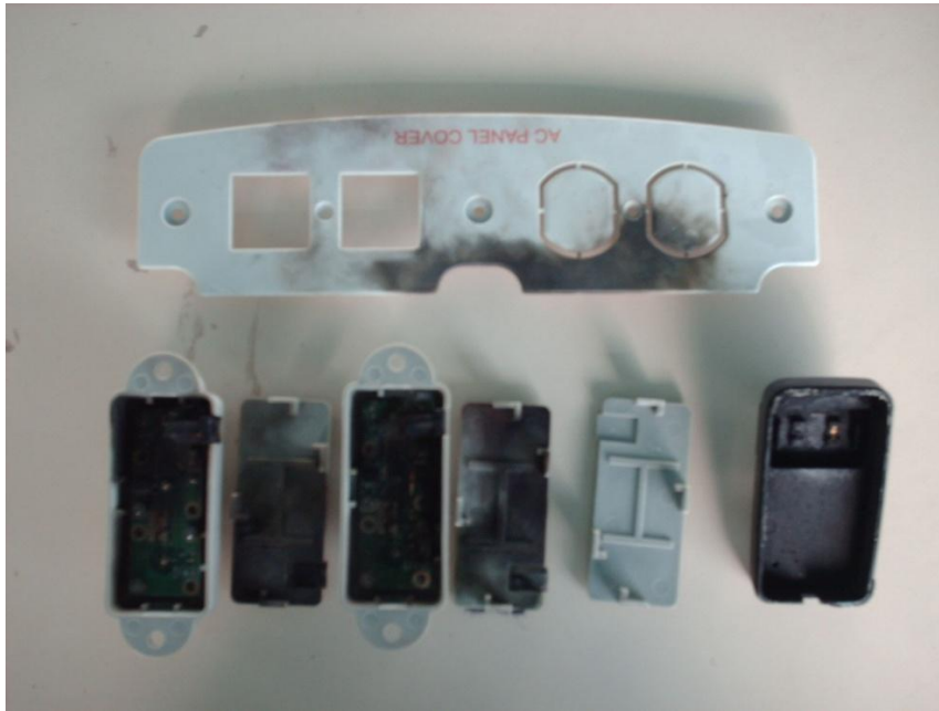
Figura 15 Detalle de los equipos inoperativos, sustituidos en la radio base de Cúpira.
