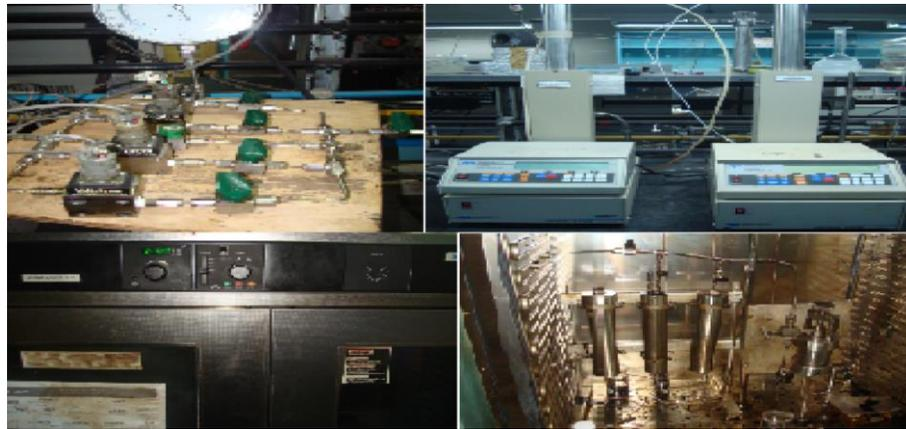
Figura 3.12 Transductores de presión y bombas de inyección (arriba)
