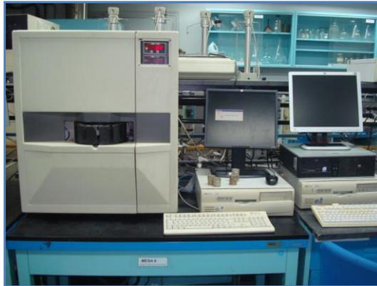
Figura 3.6 Equipo Permeámetro CMS, modelo 300
