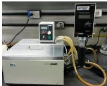
Figura 3.9 Viscosímetro CANNON V-2000.
