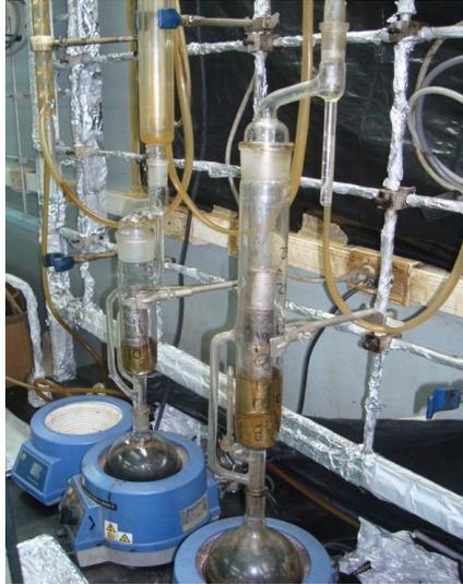
Figura 3.2 Equipo de limpieza de muestras de roca basado en el proceso de destilación-extracción Dean-Stark
