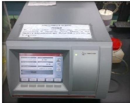
Figura 3.8 Densímetro DMA 4500 M.
