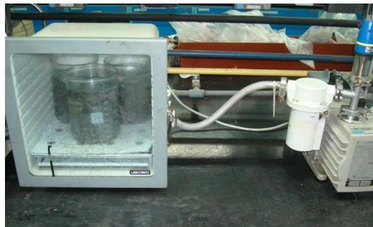
Figura 3.11 Cámara de vacío
