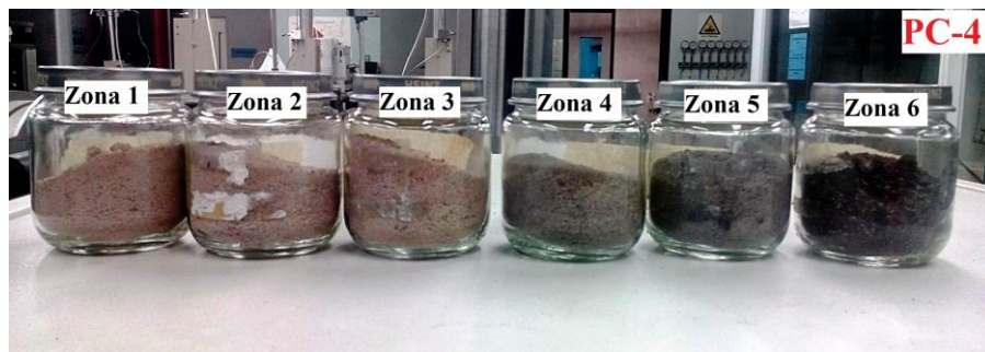
Figura C.3. Aspectos de los corte de arenas de las diferentes zonas de la celda de combustión en sitio para la prueba PC-4
