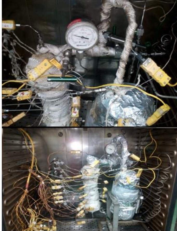
Figura 4.21 Sistema de combustión para ignición con vapor para las pruebas PC-3 y PC-4
