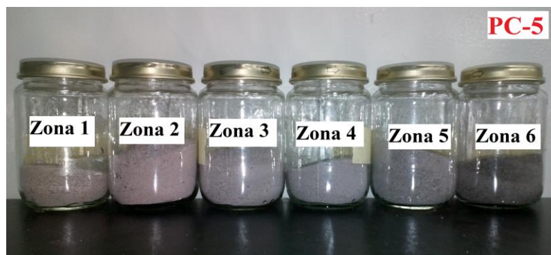
Figura C.4. Aspectos de los corte de arenas de las diferentes zonas de la celda de combustión en sitio para la prueba PC-5
