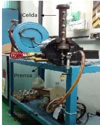
Figura 3.2 Montaje de empacado de la celda
