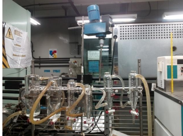
Figura 3.16 Sistema de separacion por decantación
