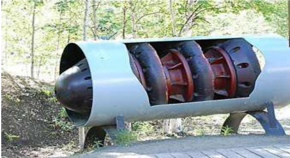
Fig. 2.30 Instrumento de remoción mecánica: brush pig (Mansoori, 2010)
