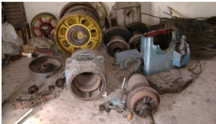
Figura 3.1. Estator y rotor de un motor asincrónico en mal estado [8].
