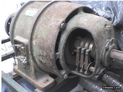
Figura 3.13 Motor asincrónico con rotor bobinado [8].
