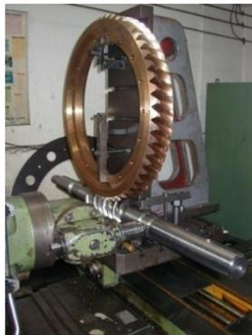
Figura 3.10. Corona recta y sinfín de un reductor, con salida a  $90^\circ$  (ortogonal) [9].
