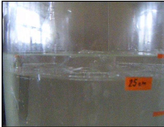
Fig. D.8. Apertura de ojo a una altura constante de 25 cm en el centro con escoria.
