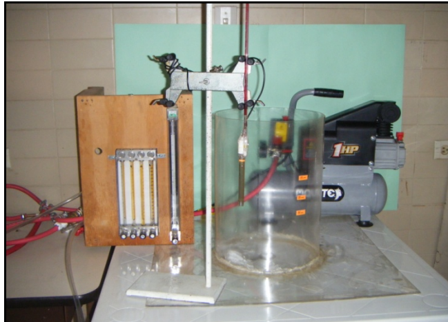
Fig. 3.11. Montaje del Modelo Físico (Cucharón) con el electrodo que registrara la medida de pH para la determinación del tiempo de mezcla.
