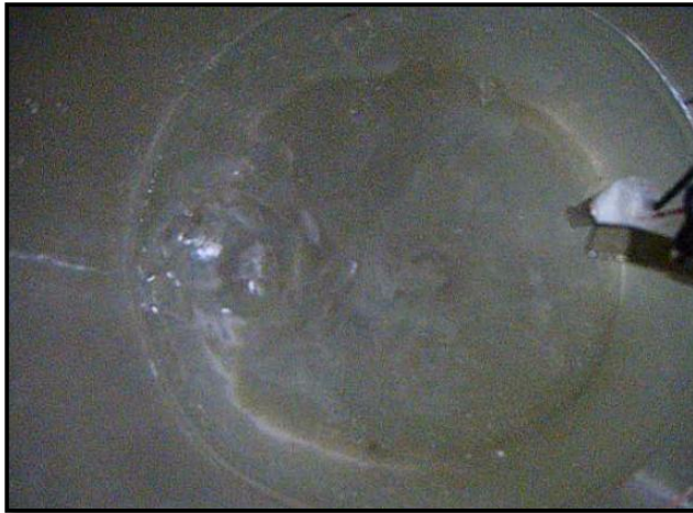
Fig. D.11. Vista superior del burbujeo a 2/3 del radio con escoria.
