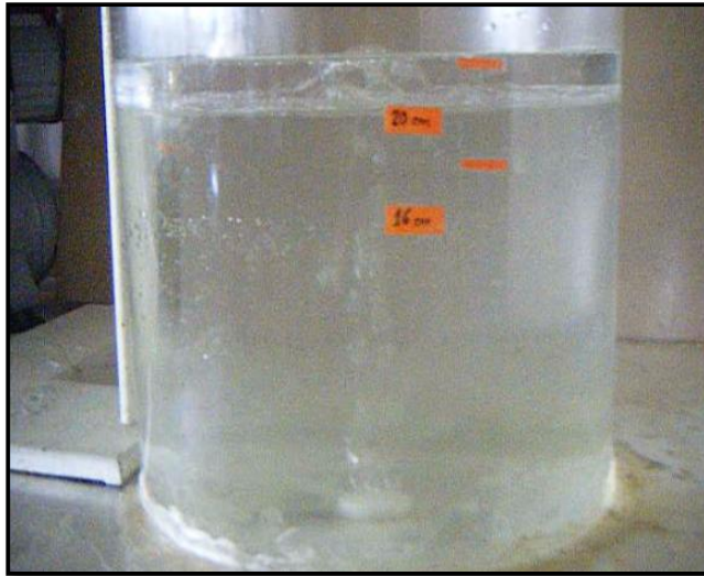
Fig. D.7. Apertura de ojo a una altura constante de 20 cm en el centro con escoria.
