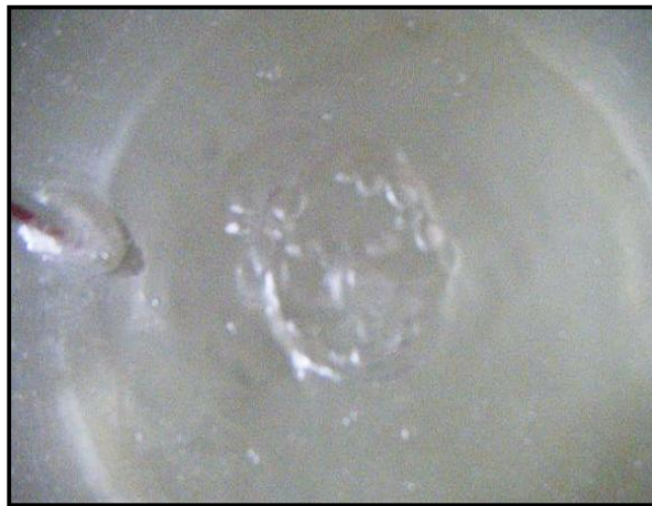
Fig. D.10. Vista superior del burbujeo en el centro con escoria.
