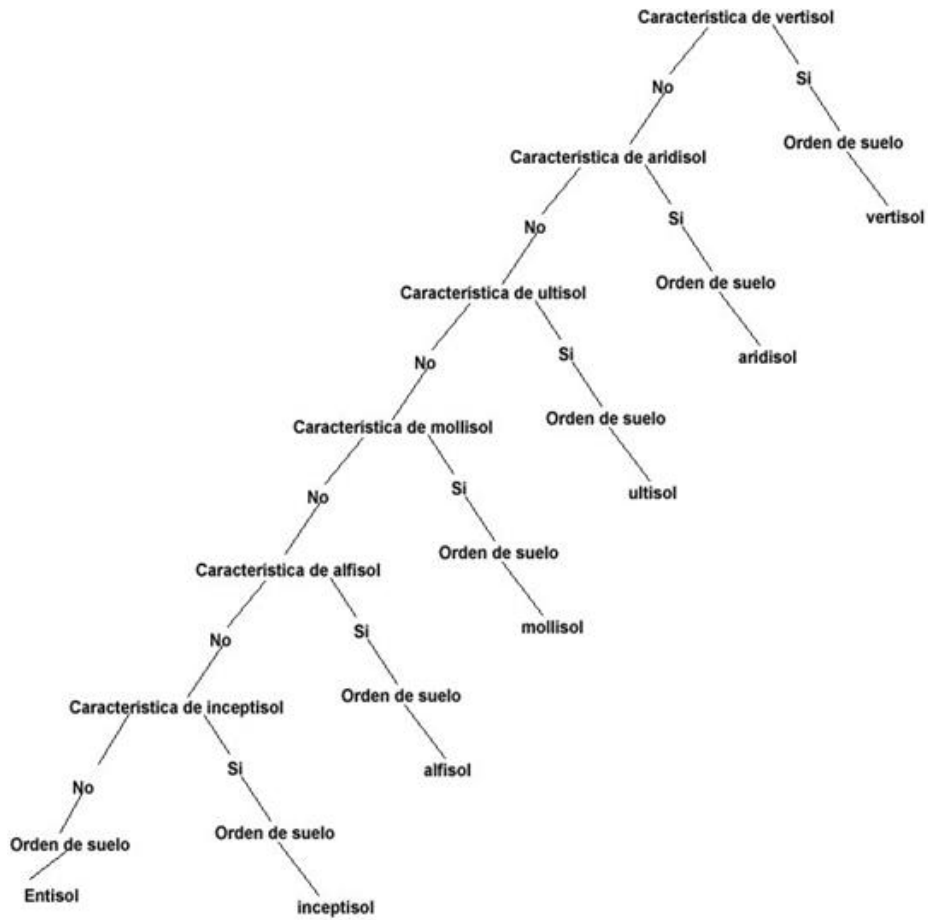
Fig. 3. Parte del árbol de decisiones para obtener el tipo de suelo referida a la muestra del estudiante.
