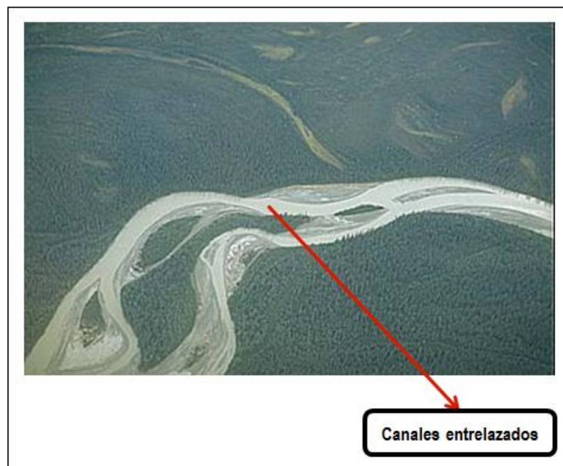
Fig. 5.29. Ejemplo de canales entrelazados en Río Tanana. Alaska, EEUU (Tomado de: http://geoimages.berkeley.edu/GeoImages/SemansAir/AirPhotos/TANABRDS.JPG )
