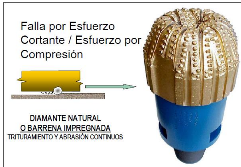
Fig. 3.37. Mecanismo de perforación de mechas impregnadas de diamante (Tomado de: Schlumberger: 2012)
