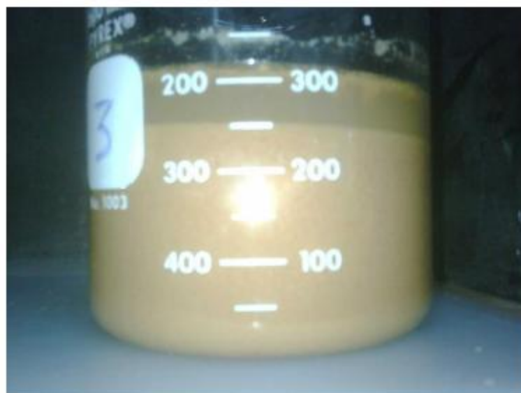
Figura B6. Proceso de floculación realizado bajo la acción del polímero Lípasa 1538
