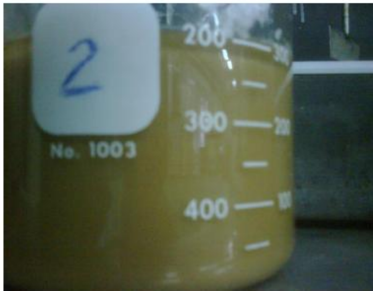
Figura B7. Proceso de floculación realizado bajo la acción del polímero Lípesa1544
