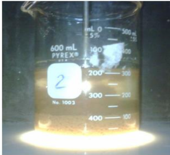
Figura B3. Proceso de floculación realizado bajo la acción del polímero Polyfloc CE1154.
