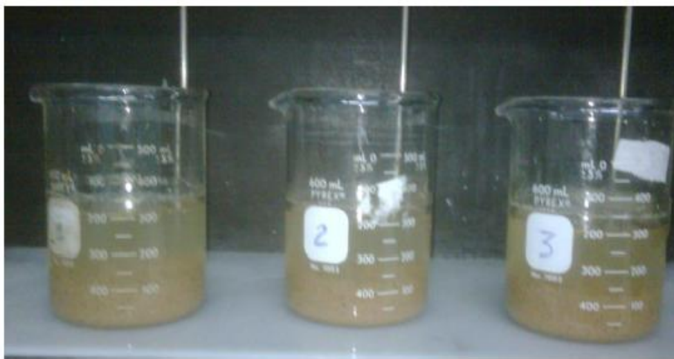
Figura B2. Proceso de floculación realizado bajo la acción del polímetro N-2680
