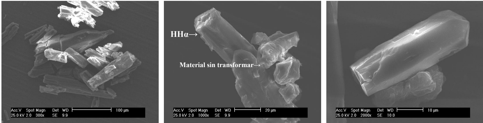
Figura 36.- Fotomicrografías de los cristales que componen el HHα9: (a) 300X (b) 1000X (c) 2000X.
