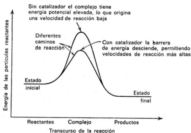
Figura 2.15. Energía de activación de una reacción catalizada y no catalizada [31]
