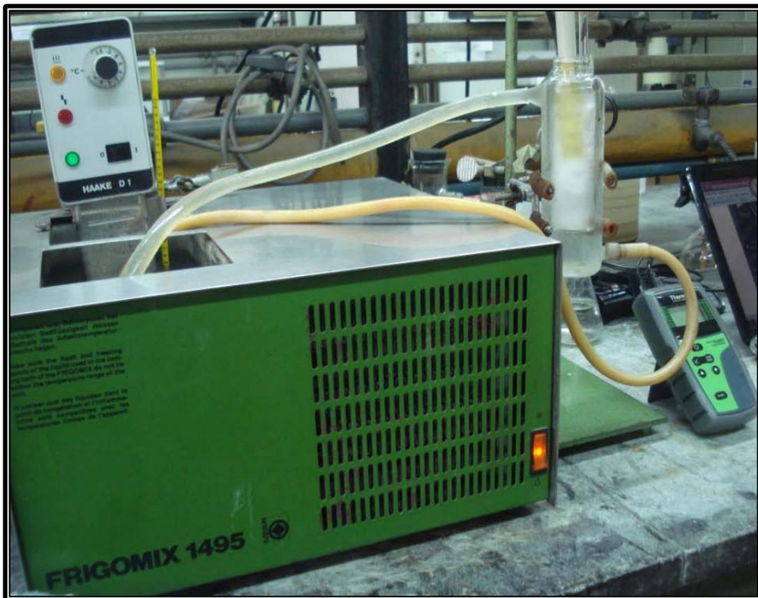
**Figura N°25a: Equipo de refrigeración para la formación y disociación de hidratos de Tetrahidrofurano.**
