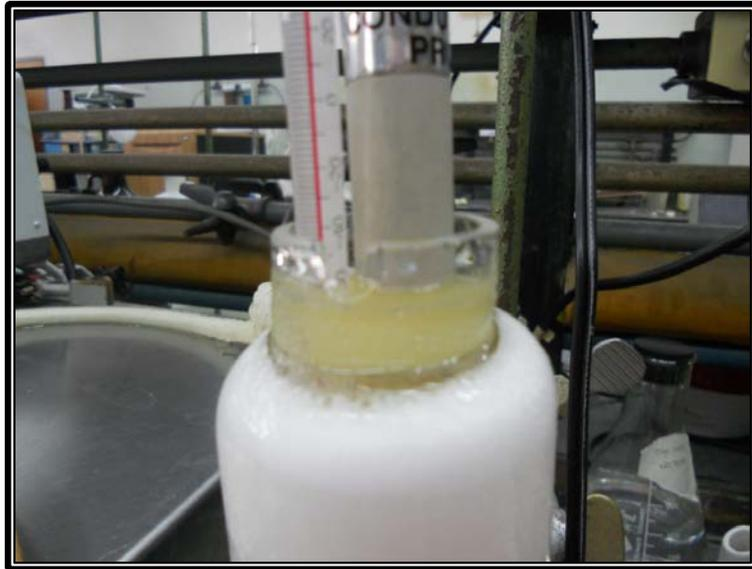
Figura N°52: Adición del extracto de Pectina posterior a la formación del hidrato.
