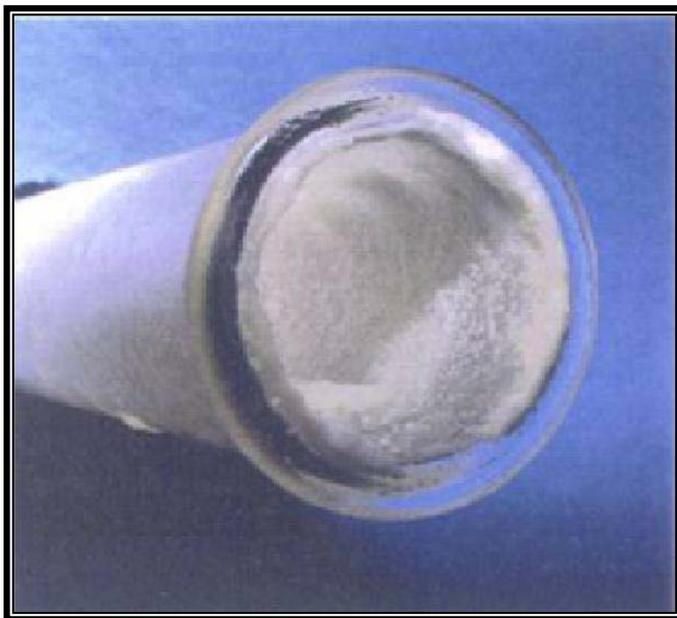
**Figura N° 10: Formación de hidratos de gas alrededor de las tuberías (Larsen, R., 2009).**
