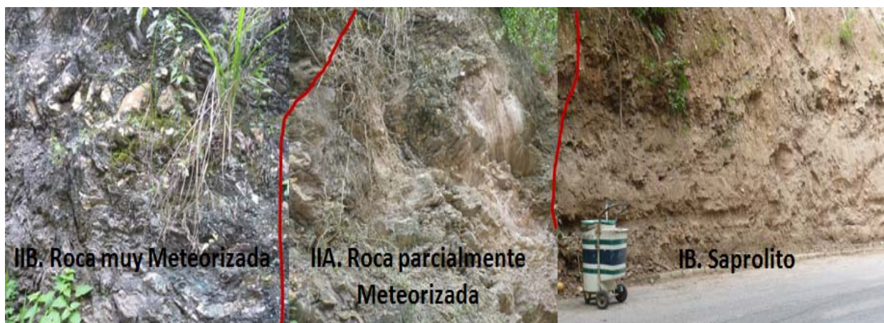
Figura 4.12. Detalle del talud en M11-ESTC 11, indicando horizontes de meteorización, nótese la variación del tipo litológico y de estructuras de deformación (plegamientos).
