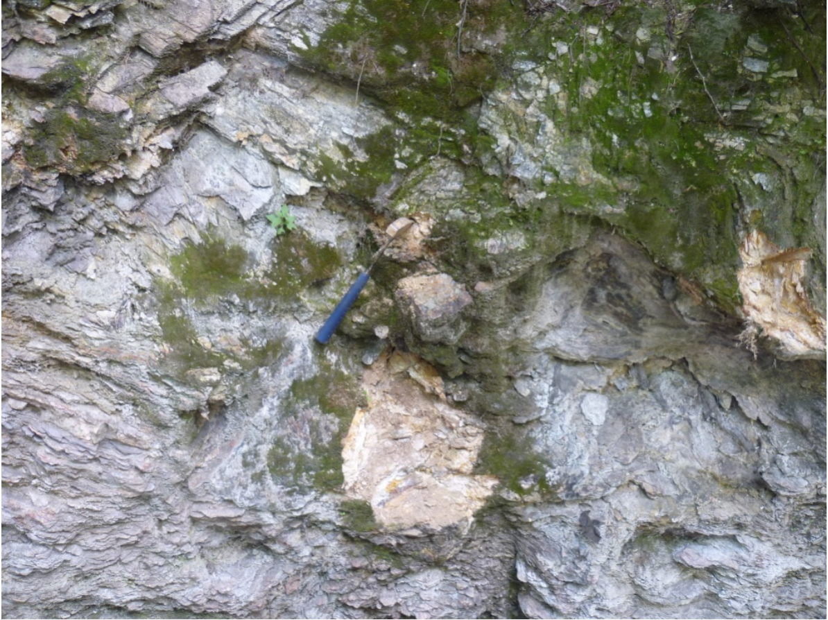
Figura 4.9. Vista detallado del intervalo descrito como horizonte II, donde se observa fragilidad y rotura en los planos de foliación al darle golpes con el martillo, exponiendo un color fresco rosado claro y para el meteorizado gris claro.
