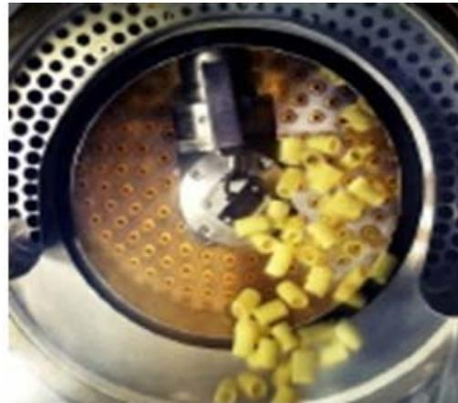
**Figura N°42-B. Funcionamiento de una cuchilla en una línea de pasta corta. Vista inferior** <sup>[10]</sup>
