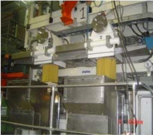
**Figura N° 42-A. Funcionamiento de una cuchilla en una línea de pasta corta. Vista frontal.** <sup>[10]</sup>
