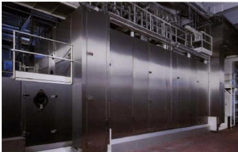
**Figura N° 43. Secador de una línea productora de pasta**
