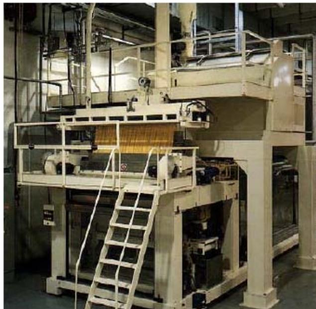
Figura N° 41. Extendedora de una línea productora de pasta larga
