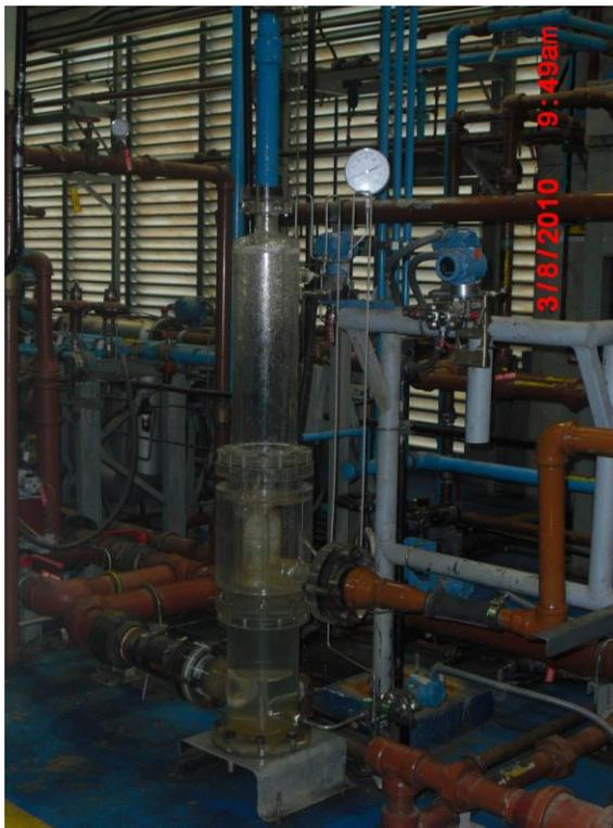
Figura N° 32: Separador CIMCI de flujo ascendente en el Circuito de separación de Norte 6.
