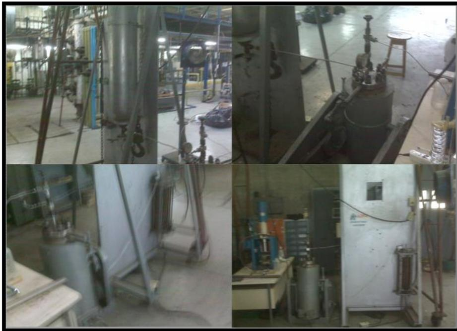
**Figura N°35 Equipo de Extracción con Fluido Supercrítico.**
