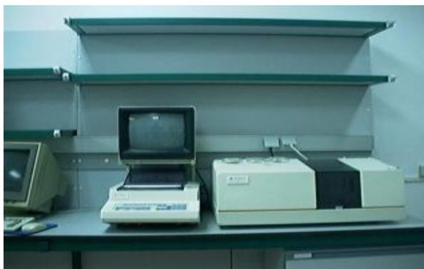
**Figura N°13 Equipo de Espectroscopia de Infrarrojo de doble haz (Rius, 2007).**
