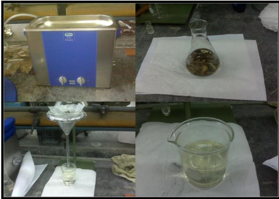
**Figura N°34 Extracción Asistida por Ultrasonido.**
