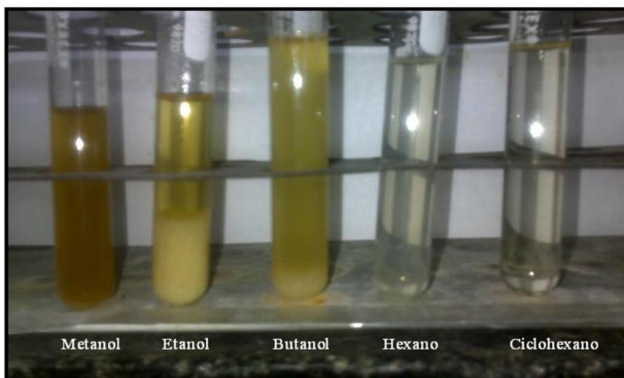
**Figura N°21 Conjunto de Muestras Resultantes de la Extracción con el Equipo Tipo Soxhlet con diferentes solventes.**
