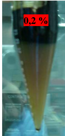
Figura 70. Desmulsificación de la emulsión de 0,2 % de álcali.
