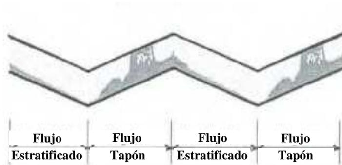
**Figura 7. Proceso de formación de un tapón de líquido por efecto de la topografía del terreno.**
