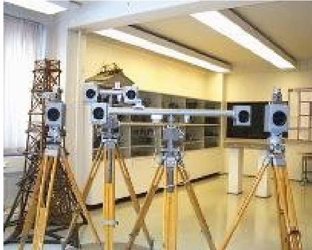
Figura 5. Cámara Terrestre Métrica. (UCV)
