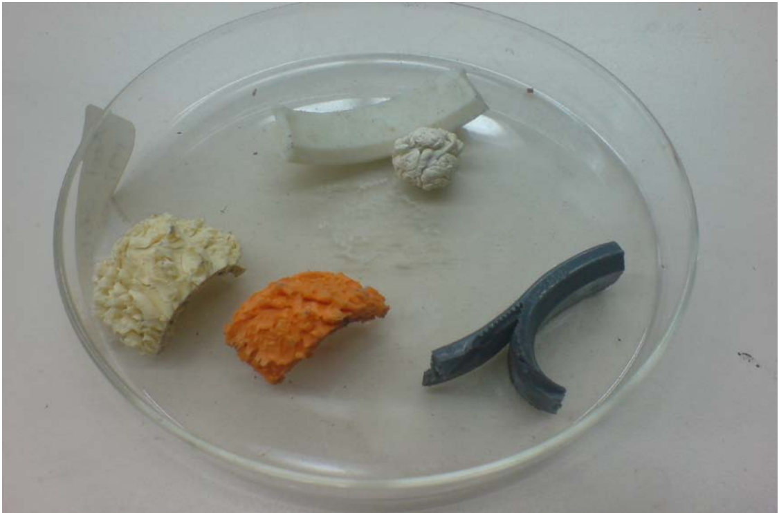
Figura N°19 Termoplásticos después de la prueba de inocuidad a condiciones ambientales (Fuente: Propia Elaboración).
