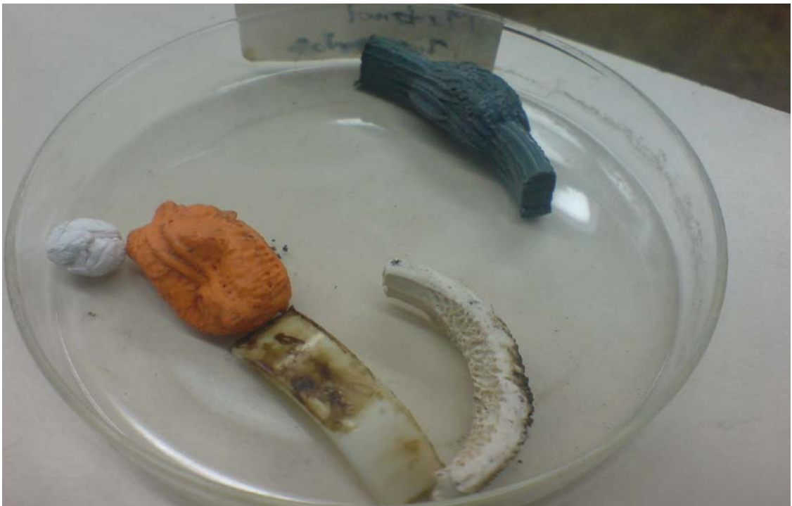
Figura N°18 Termoplásticos después de la prueba de inocuidad a condiciones de trabajo (Fuente: Propia Elaboración).
