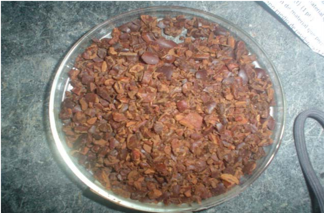
Figura N°27 Semillas de cacao trituradas antes del proceso de extracción (Fuente: Propia Elaboración).
