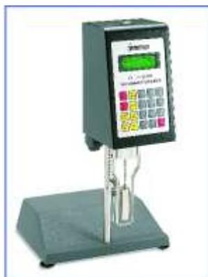
Figura N° 28: Reómetro digital Brookfield DV-III Ultra. ( Brookfield, S/A)
