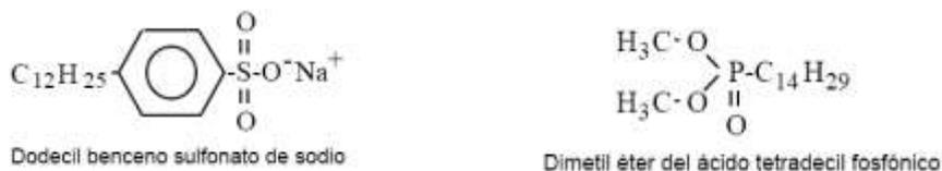
Figura N° 7: Ejemplos de surfactantes aniónicos (Salager, 2002).
