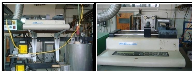
**Figura N°7:** Sistema de inyección de reactivos líquidos
