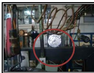
**Figura N°3:** a) Manómetro cabeza de columna
