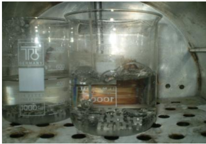
Figura 19. Pruebas en Estado Estático con Inclusión de \text{CO}_2 .
