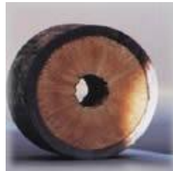
Figura 8. Incrustación de Carbonato de Calcio originada por Aguas de Producción.
