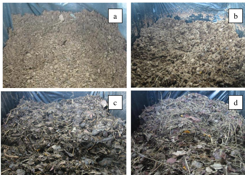
Figura N° 41. Imágenes de producto final a los treinta días (a) Producto del compostero de estructurante A relación 1:1, (b) Producto del compostero de estructurante A relación 2:1, (c) Producto del compostero de estructurante GH relación 1:1 y (d) Producto del compostero de estructurante GH relación 2:1.
