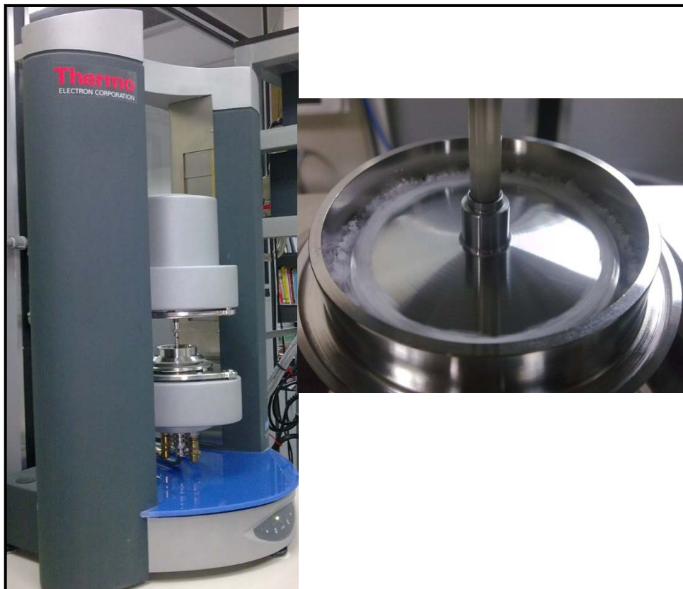
Figura 53. Vistas del proceso de evaluación de la variación de la viscosidad en la deshidratación de gypsum, en el reómetro.
