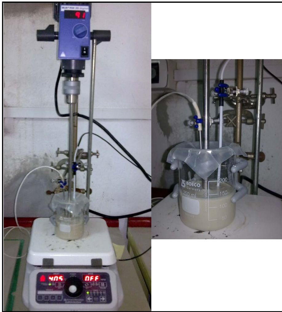
Figura 50. Montaje experimental realizado para la obtención de yeso alfa, a presión ambiental.
