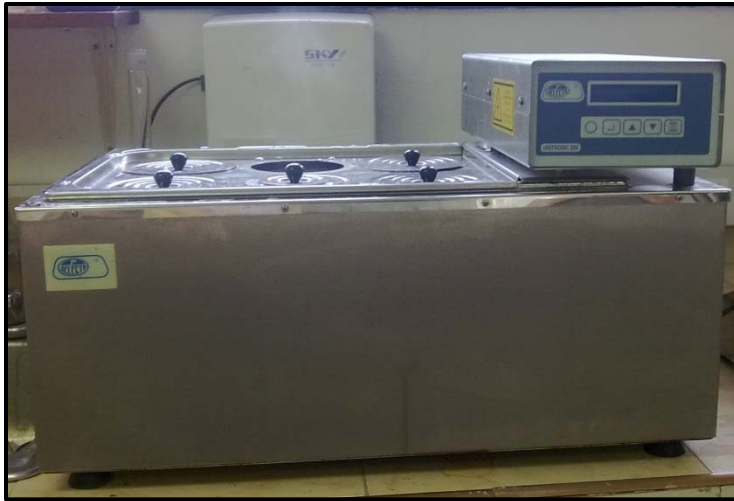
Figura 52. Evaporador empleado para aplicar prueba de corrosión a piezas de Acero Inoxidable 304 y Titanio
