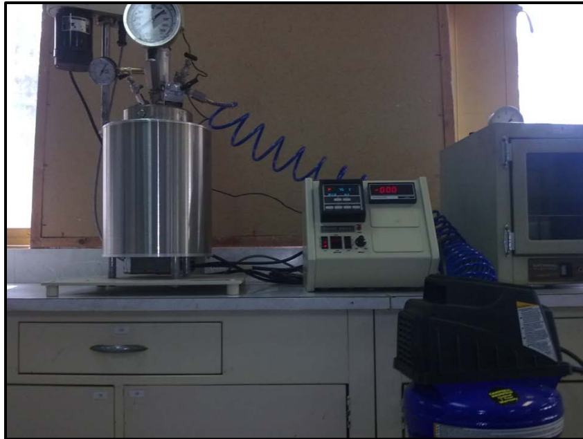
Figura 55. Autoclave y accesorios para la evaluación de la producción de \alpha\text{-CaSO}_4\frac{1}{2}\text{H}_2\text{O} , en autoclave.
