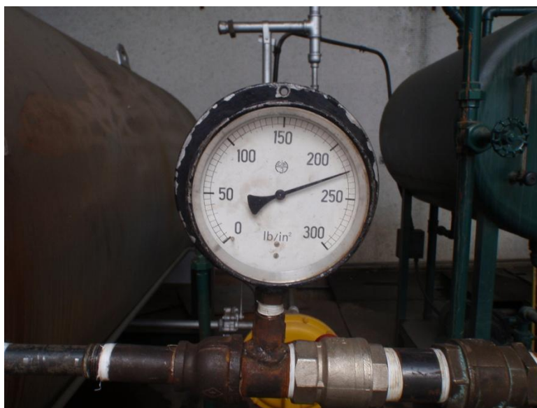
Figura N° 16. Presiones alcanzadas durante prueba hidrostática.
