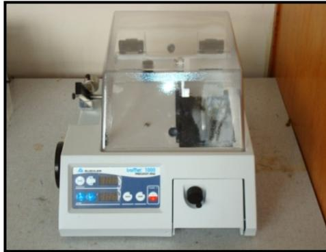
**Figura 9.** Cortadora de precisión BUEHLER, ltd., ISOMET 1000.
