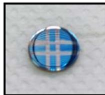
**Figura 19.** Muestra de acero con recubrimiento, acondicionada para medir espesor en MFA.
