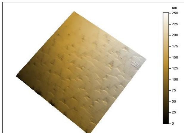
**Figura 26.** Imagen 3D de la superficie del recubrimiento de  $\text{TiO}_2$  obtenido a una distancia sustrato-cátodo de 2cm y presión de operación de 0,14mbar.
