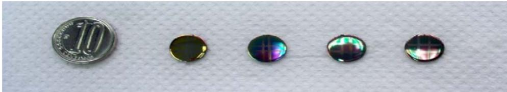
**Figura 33.** Fotografía de muestras de Acero Inoxidable 316L con diferentes espesores de película de  $\text{TiO}_2$  (Espesores de izq. a der.: 100, 150, 350 y 400nm).
