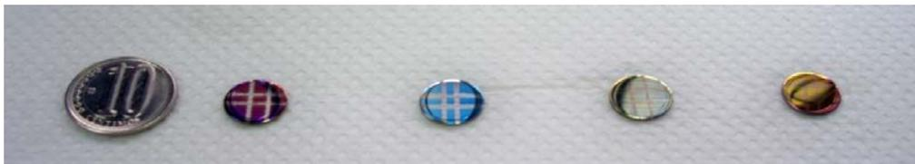
**Figura 35.** Fotografía de muestras de Acero Inoxidable 316L con diferentes espesores de película de TiN (Espesores de izq. a der.:25, 50, 100 y 140nm).
