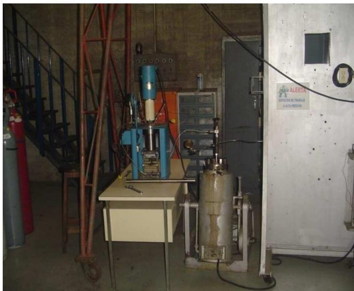
Figura N°26: Equipo de extracción Supercrítica.
