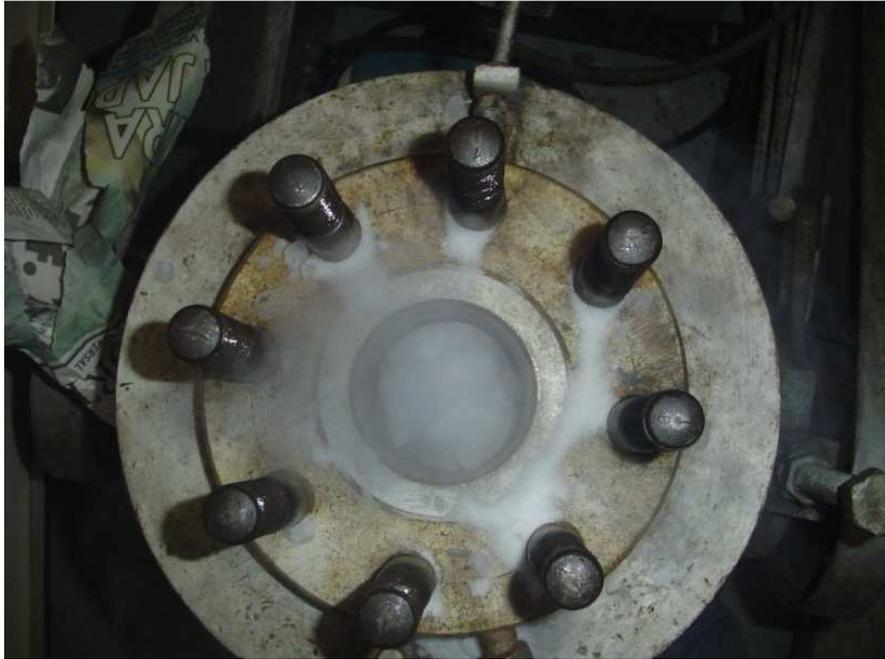
Figura N° 30: Autoclave de presurización RP-01 con CO<sub>2</sub>
