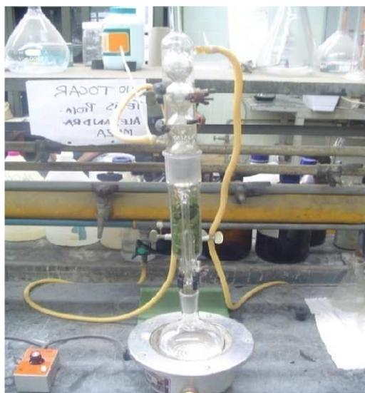
Figura N°29: Montaje tipo soxhlet
