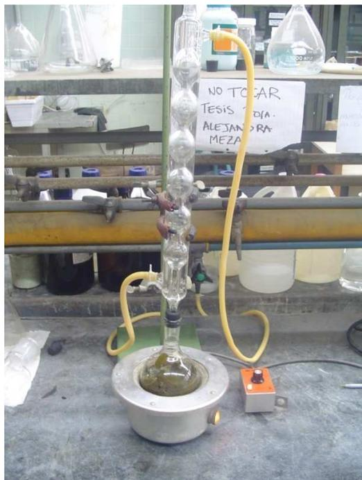
Figura N°28: Montaje de prueba de hidrodestilación
