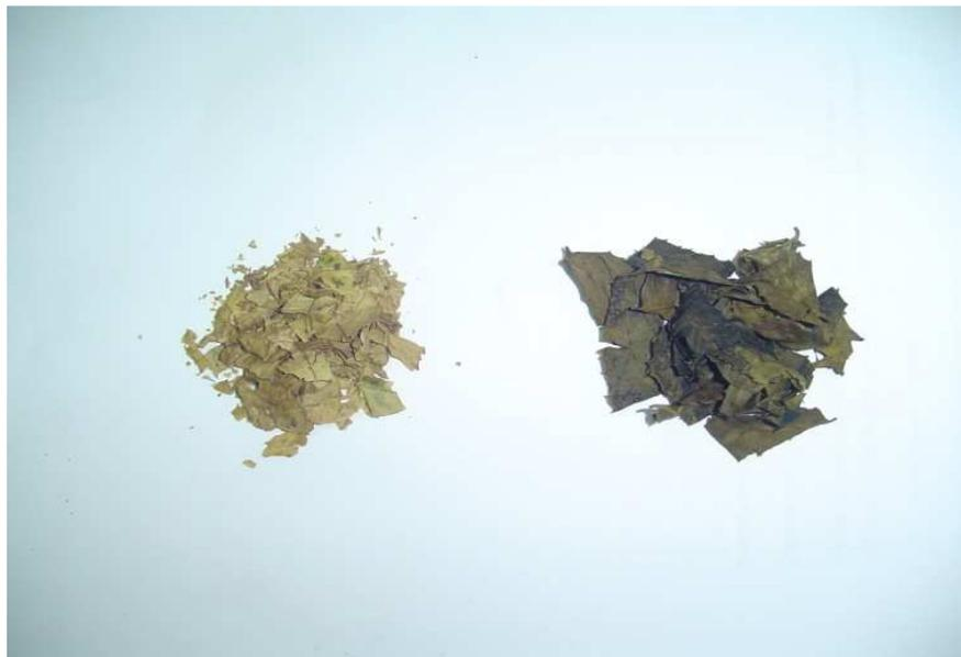
Figura N° 31: Diferencia entre las hojas después del proceso de extracción con el método soxhlet (Izquierda) y con el método de hidrodestilación (Derecha)
