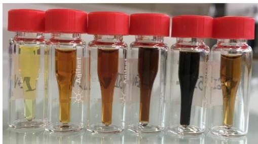
Figura 13. Fracciones de crudo, separadas por cromatografía en columna.
