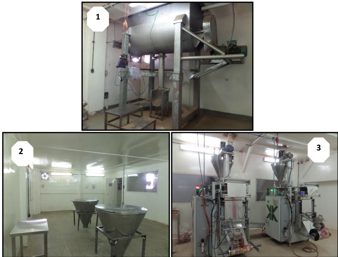
Figura 8: Equipo de producción: Mezcladores (1), Tolvas (2) y Enfardadoras (3).
