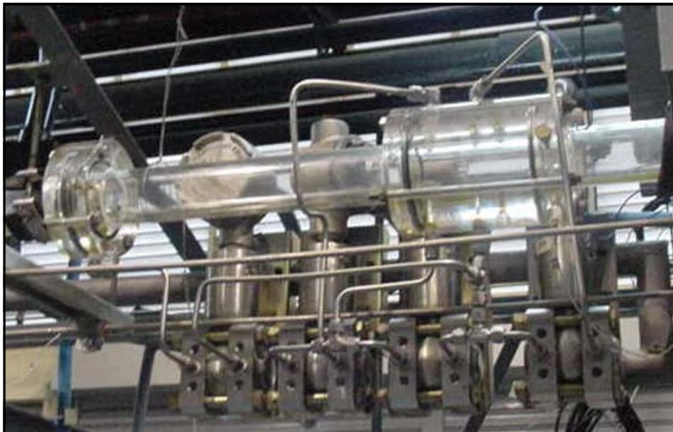
Figura N° 16 Segmento de la zona de visualización de los patrones/transiciones del circuito experimental en Intevep.
