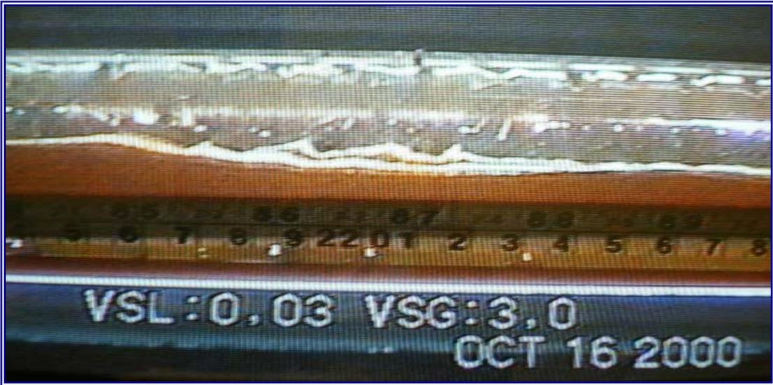
Figura N° 20 Imagen de Patrón de flujo “Estratificado Ondulado” en sistema aire - Purolub 320, en tubería horizontal de 5cm de diámetro.
