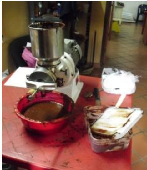
Figura 4.9. Descascarilladora de la Escuela de Chocolatería de la ALBA, nibs y cascarilla de los granos de cacao
