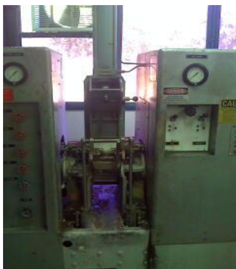
Figura N° 4.1: Mezclador interno Banbury
