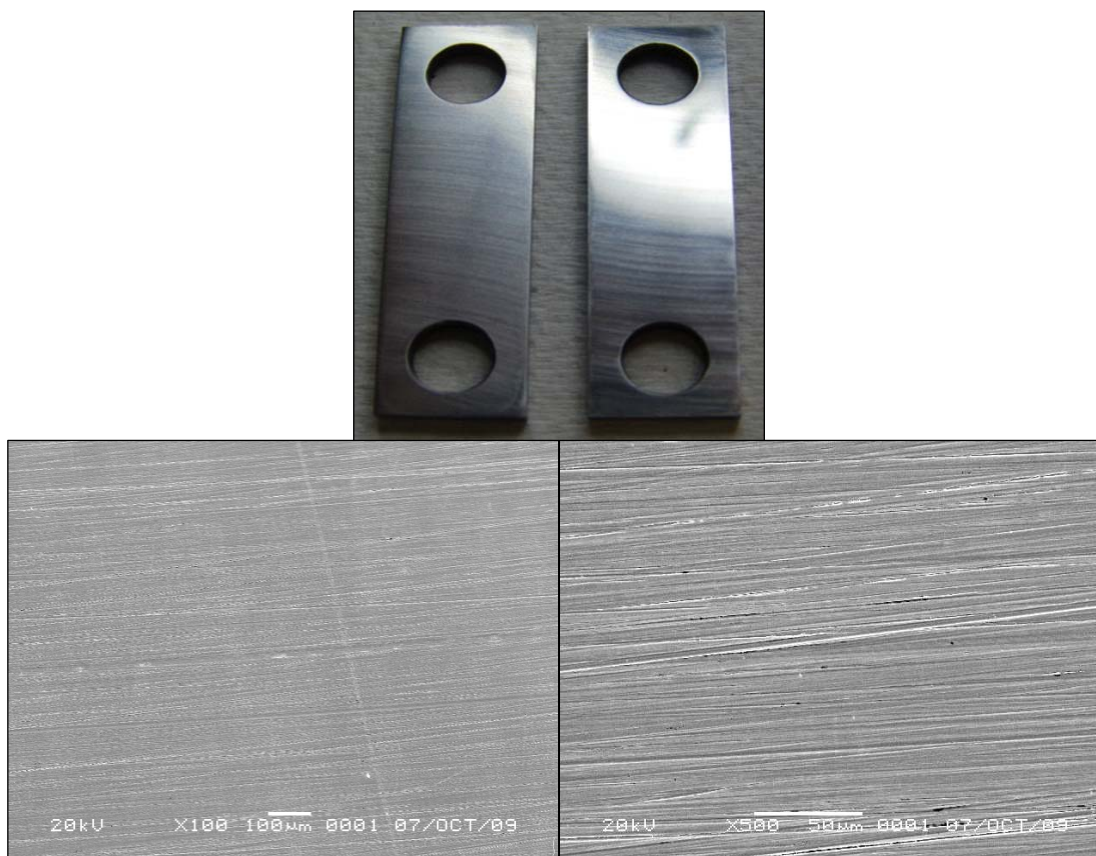
Figura 42. Estado inicial de las probetas de acero API 5L X65
