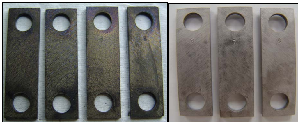
Figura 46. Estado de las probetas sometidas a INTAV TM , antes y después de decapar
