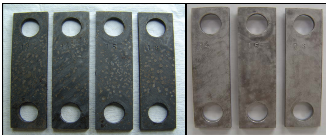
Figura 53. Estado de las probetas sometidas a INTAV™ más 150ppm de dodecilamina, antes y después de decapar
