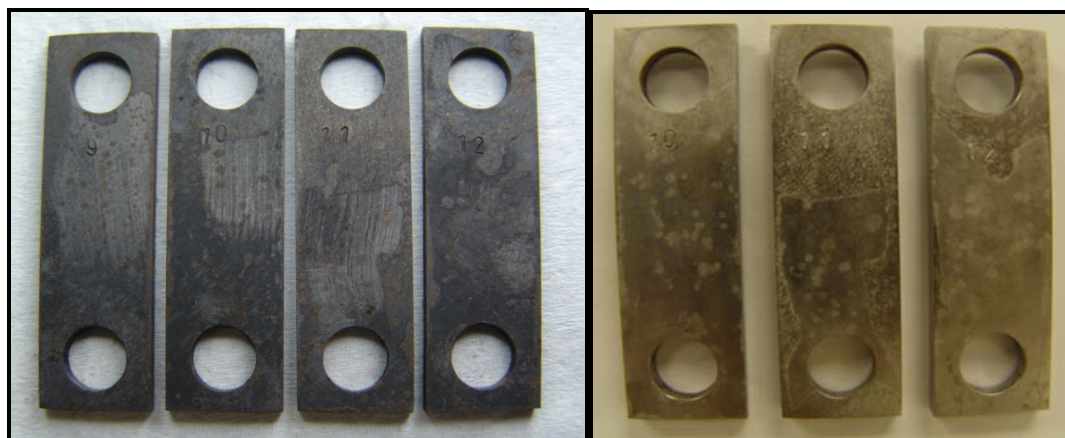
Figura 50. Estado de las probetas sometidas a INTAV™ más 50ppm de dodecilamina, antes y después de decapar
