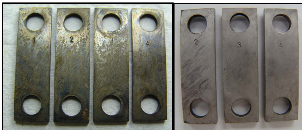
Figura 43. Estado de las probetas evaluadas en el blanco, antes y después de decapar
