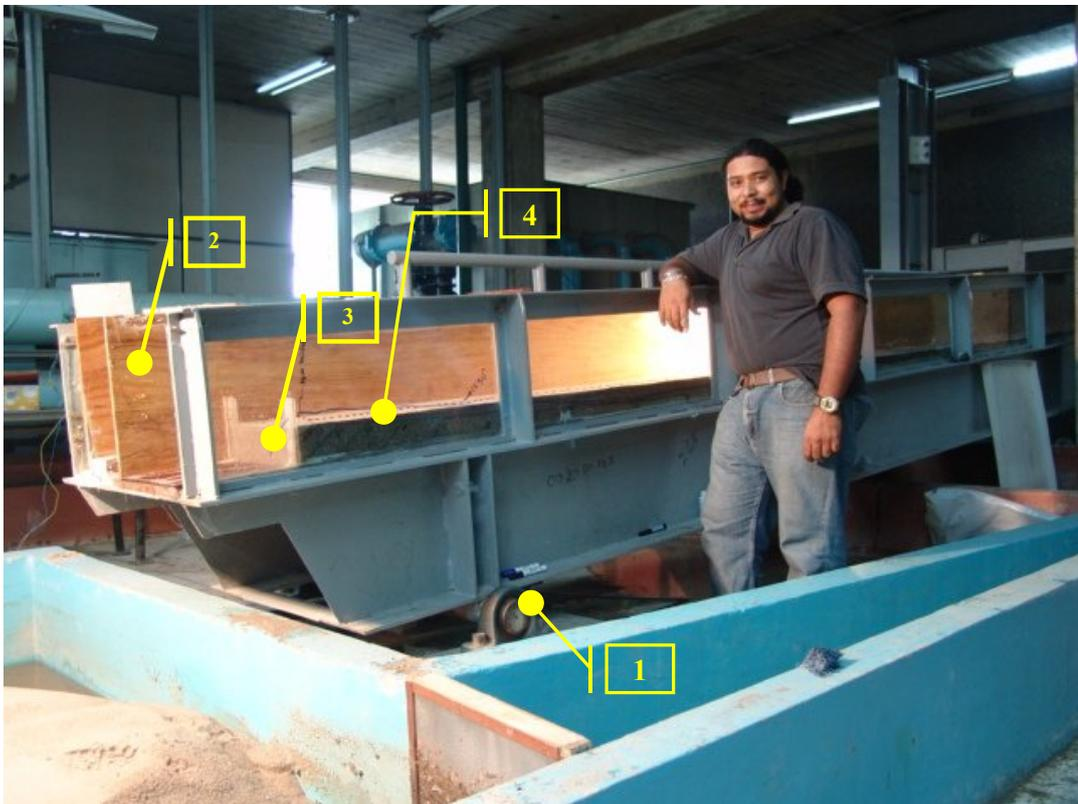
**Figura 21.** Foto del canal de laboratorio donde puede apreciarse: (1) pivote que permite graduar la pendiente. (2) Ajuste del ancho mediante la instalación de una margen derecha en madera. (3) Instalación del dique (presa) transversa a la corriente. (4) Obtención de la pendiente final en una experiencia, después de la sedimentación del lecho.
