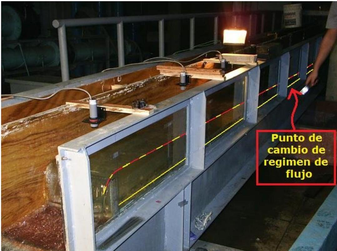
**Figura 88.** Foto del ensayo 1 donde se ve claramente que el perfil M1 comienza a formarse aproximadamente a 6 metros de la presa.
