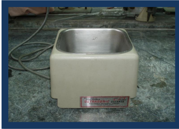
Figura 16. Equipo de ultrasonido empleado en las experiencias de EAU.
