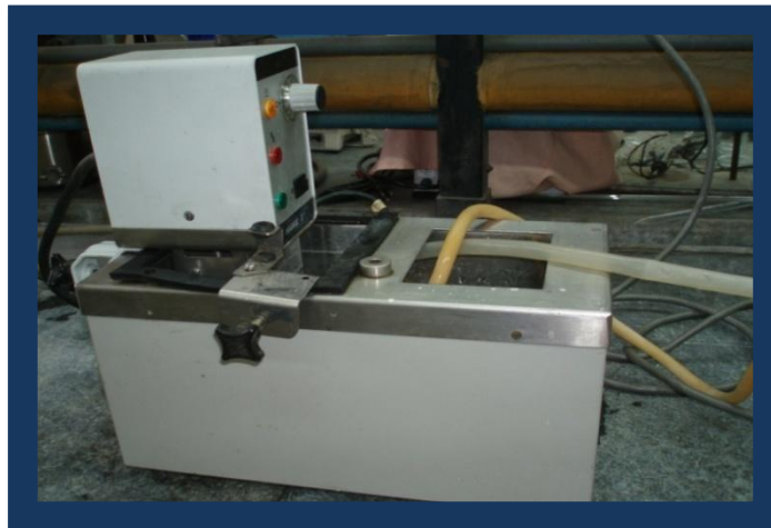
Figura 17. Baño termostático empleado en las experiencias de EAU.
