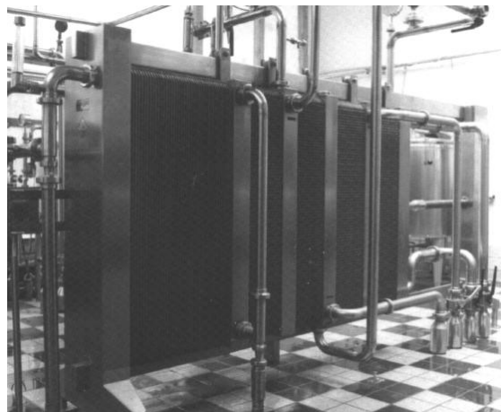
Figura 2. Intercambiador de calor de placas. Tomado y modificado de Fellow (2000).
