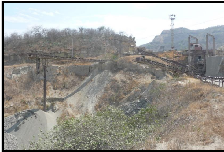
Figura 5. 7 Planta de trituración primaria
