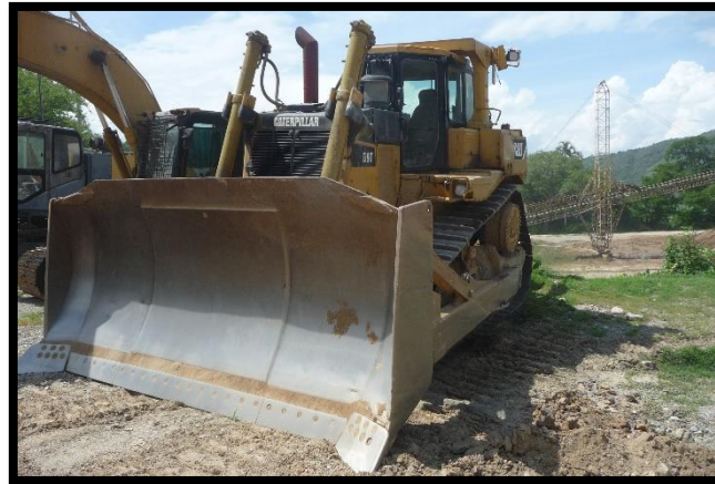
Figura 3. 8 Tractor sobre orugas CAT D9T Fuente: por el autor, Canteras Curas C.A, 2016
