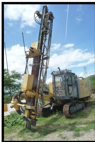
Figura 3. 7 Perforadora hidráulica XCMG
