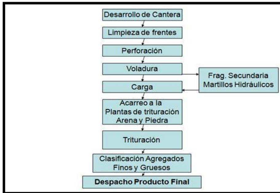
Figura 3. Esquema de proceso productivo de la empresa
