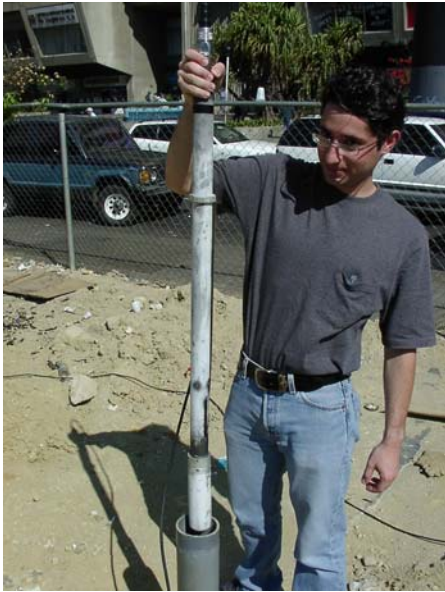
Figura 34. Instrumentos empleados durante la adquisición. Izquierda: geófono de pozo. Derecha: Mandarría y armazón metálico empleado para generar ondas “S”.
