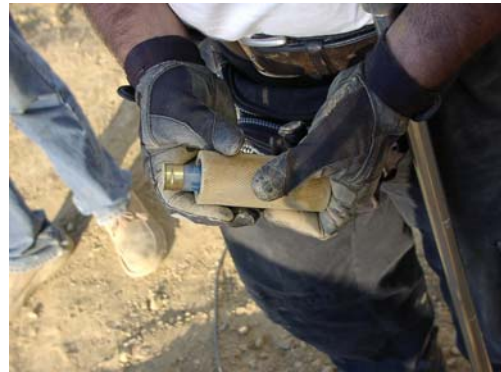
Figura 45. Izquierda: Visualización del “shotgun”. Derecha: Colocación de un cartucho en la pieza inferior del “shotgun”.
