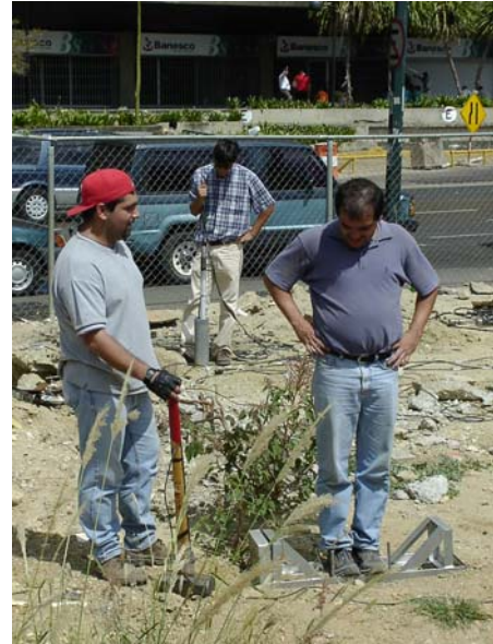
Figura 34. Instrumentos empleados durante la adquisición. Izquierda: geófono de pozo. Derecha: Mandarría y armazón metálico empleado para generar ondas “S”.
