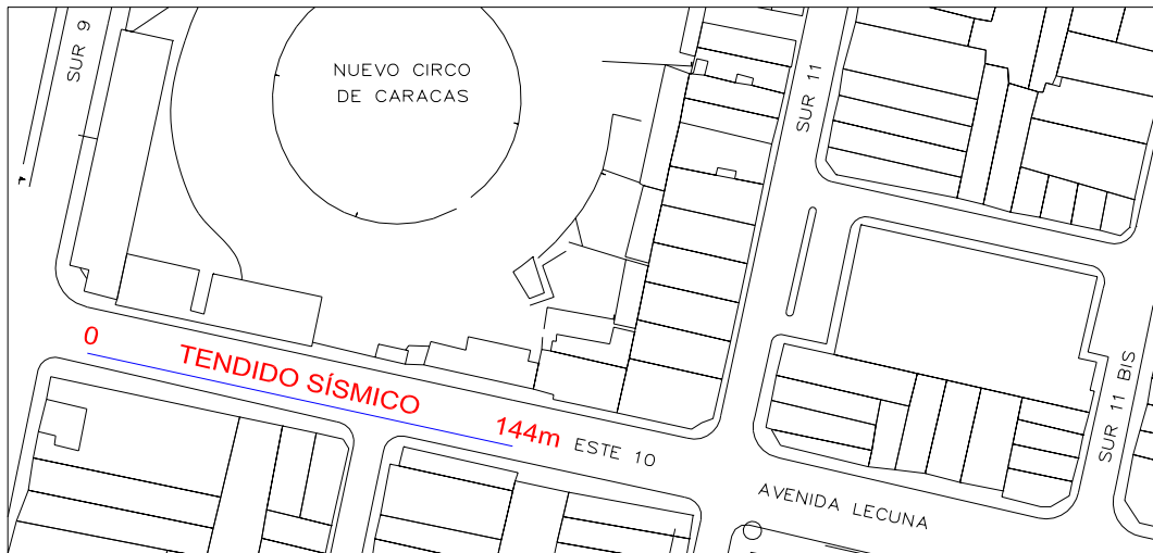
Figura 48. Ubicación del tendido sísmico de refracción llevado a cabo en el Nuevo Circo de Caracas, la medición se realizó dentro de la futura estación Nuevo Circo aproximadamente a 3 metros de profundidad debajo del nivel de la calle.
