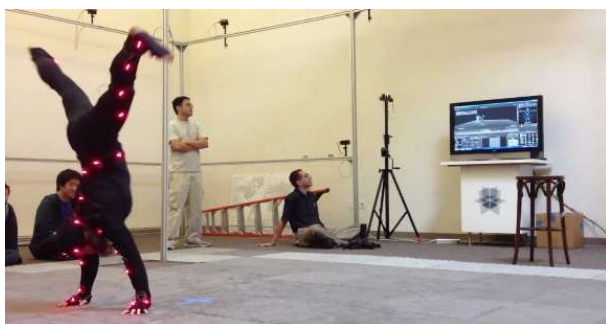
Fig. 1.18 Sistema de captura de movimiento activo profesional creado por la compañía Pshase Space
