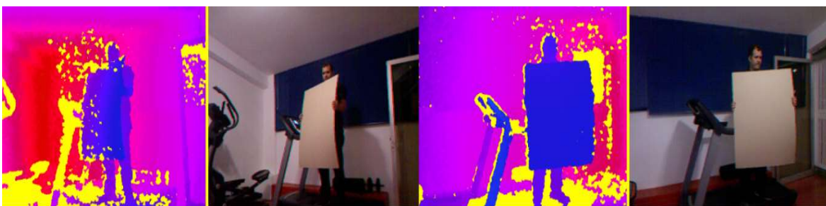
Fig. 4.7 Proceso de calibración de la primera configuración con doble Kinect
