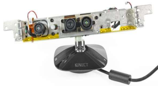
Fig. 2.3 Kinect sin la carcasa, donde se pueden apreciar los componentes de izquierda a derecha, Sensor CMOS a color, Sensor de profundidad CMOS monocromatico y luz infraroja.
