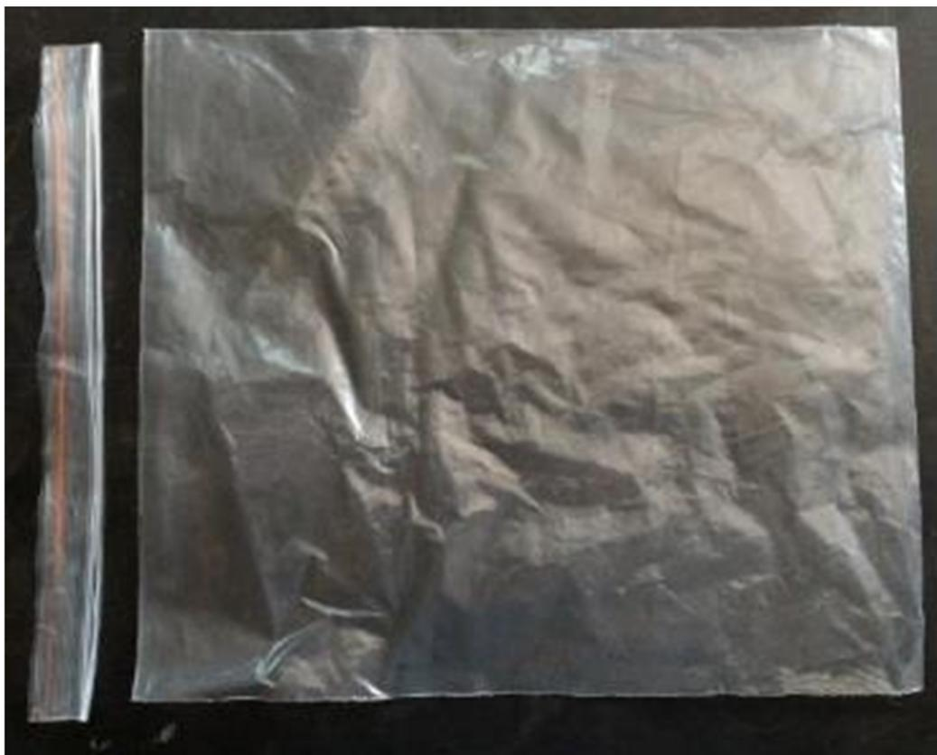
**Figura 12** Bolsa de Polietileno de Baja Densidad sin el cierre de tipo clic
