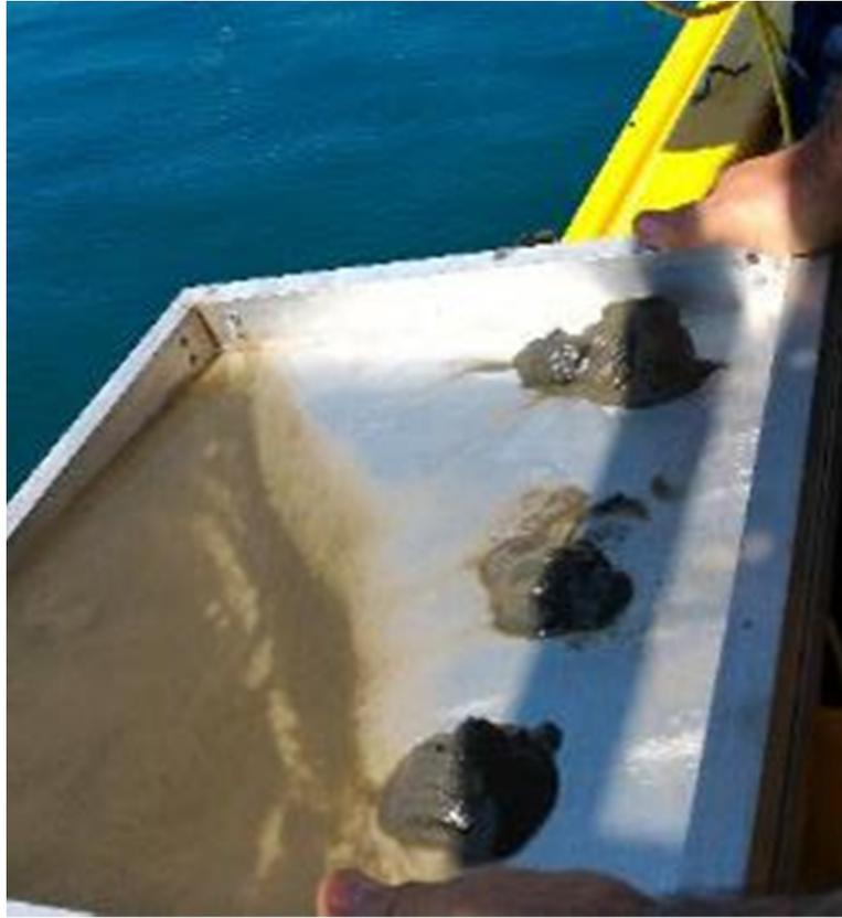
**Figura 23** Escurrimiento de agua en las muestras de sedimento.
