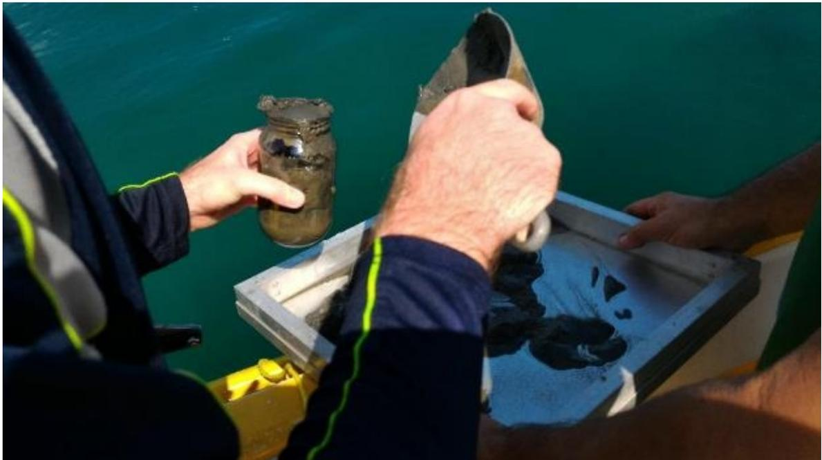
**Figura 24** Almacenaje de sedimento en envases de vidrio.
