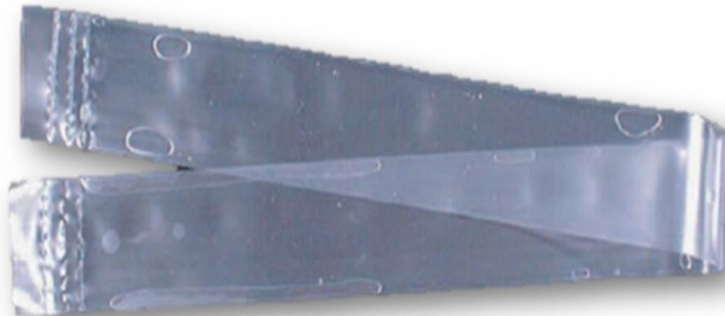
**Figura 8** Membrana semipermeable de polietileno de baja densidad (LDPE por sus siglas en inglés). (Tomado de Lorimor,2016).
