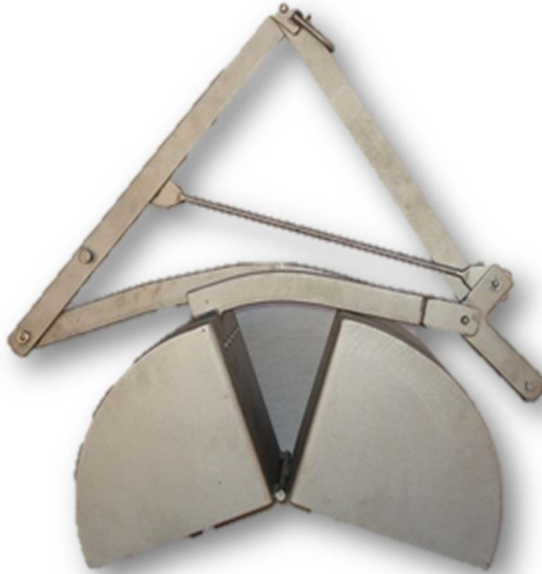
**Figura 7** Draga de tipo Petersen. (Tomado de: Limnotec, 2012)
