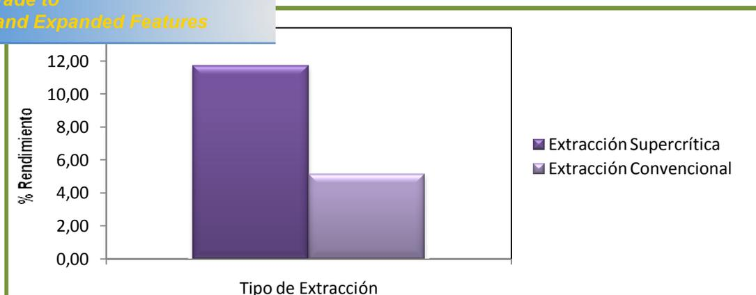
Figura N° 21. Comparación de los métodos de extracción en base al rendimiento
