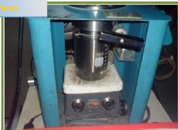
Figura N° 13. Fotografía del sistema de calentamiento para el reactor de extracción.
