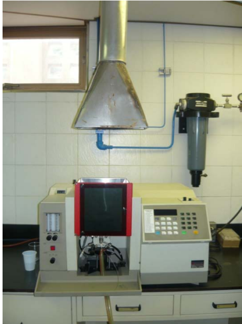
Figura 12. Equipo de Absorción Atómica utilizado para el Análisis Iónico de los Cationes presentes en el Agua de Proceso.
