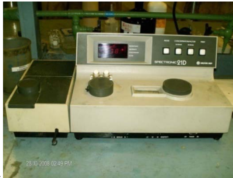
Figura 11. Espectrofotómetro utilizado para la medición de Sílice. Equipo ubicado en el Laboratorio de la Unidad 8 de Planta Ampliación Tocoa, donde este método es un análisis de rutina.
