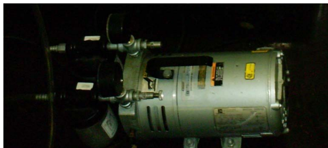
Bomba de Vacío utilizada para Drenar al Agua de las Muestras aplicando Succión.
