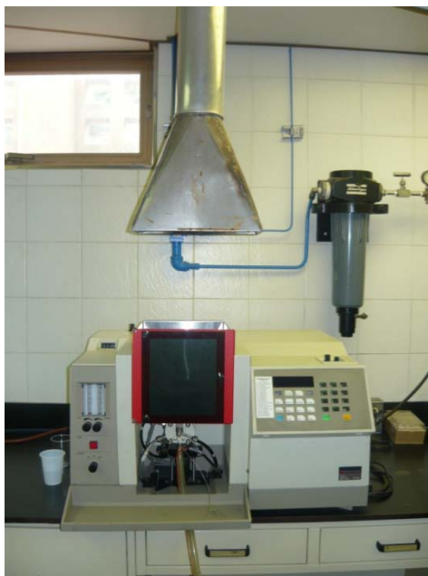
Equipo de Absorción Atómica utilizado para el Análisis Iónico de los Cationes presentes en el Agua de Proceso.
