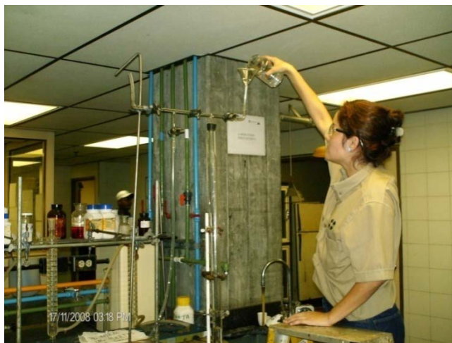
Figura 64. Adición de Cloruro de Sodio durante el Pretratamiento.
