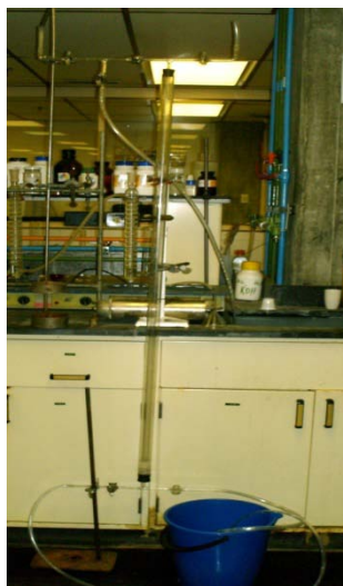
Columna de Pretratamiento de 1,5 m. de altura, fabricada según la Norma ASTM D 2688 en el Taller de Soplado de Vidrio de la Facultad de Ciencias de la Universidad Central de Venezuela.
