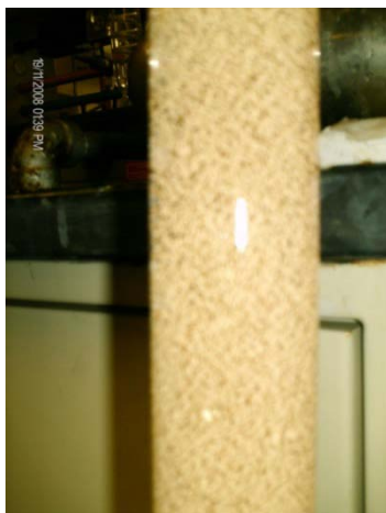
Figura 61. Fluidización de las Resinas durante el Retrolavado en el Laboratorio.
