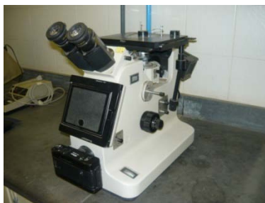
Microscopio Óptico utilizado en el Análisis de las Muestras de Resina de Intercambio Iónico.
