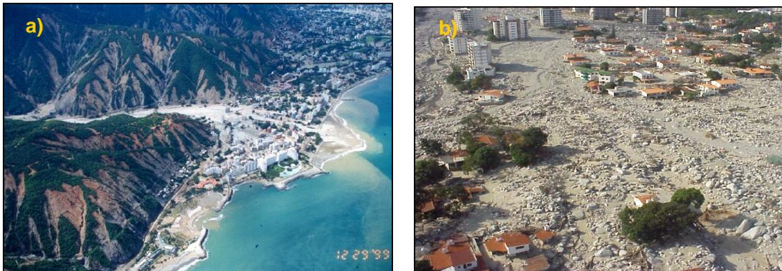
**Figura 2.10a.** Deslizamientos que desencadenaron los aludes torrenciales en el Estado Vargas en diciembre de 1999. **Figura 2.10b.** Parte del material sólido que bajó de la montaña en diciembre de 1999 en el estado Vargas. Fuente: IMF, 2005.
