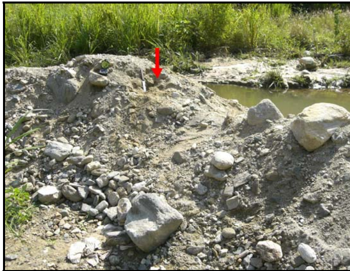
Figura 6. Sitio de captación de la muestra en el depósito excavado en el vaso del embalse Macuto. Nótese presencia de peñones de 45 cms. de diámetro
