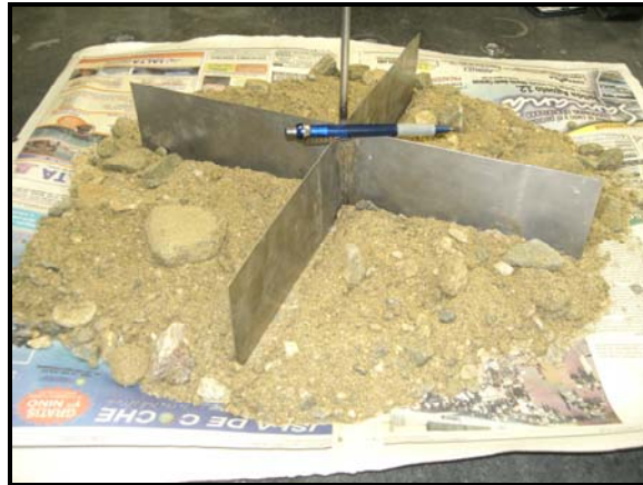
Figura 7.- Procedimiento de cuarteo de la muestra de campo.
