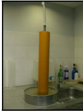
Figura 8.- Permeámetro utilizado en el laboratorio del IMF para medir la conductividad.
